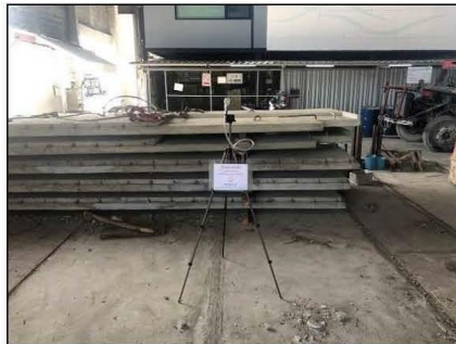
โรงงานผลิต HC : บริเวณหัว Line ตรวจวัด Total Dust
