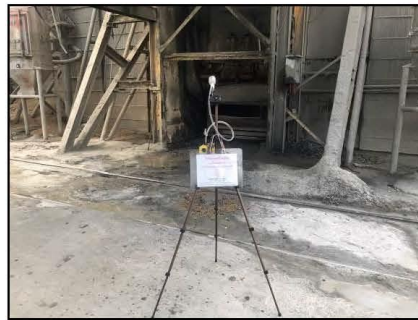
โรงงานผลิต Plank คลังสินค้า : บริเวณใต้เครื่องไม้ 2 ตรวจวัด Total Dust
