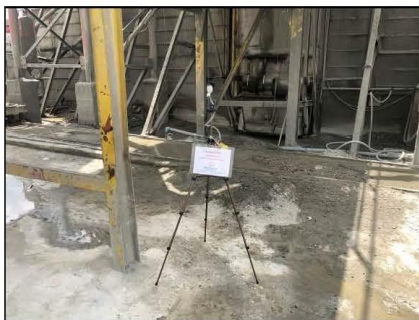
โรงงานผลิต Plank คลังสินค้า : บริเวณใต้เครื่องไม้ 3 ตรวจวัด Total Dust
